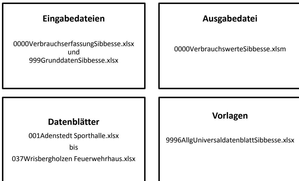
Abbildung 13: Aufbau des Energiecontrollingsystems
